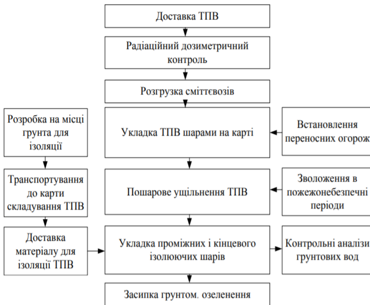
Рисунок 3.1 – Схема основних процесів та операцій, які виконуються при експлуатації полігонів ТПВ [7]
