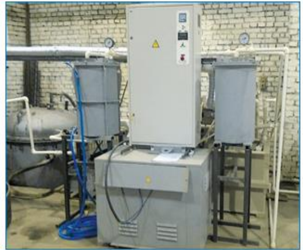
Рисунок 3.2 – Технологічна схема установки очищення бурових розчинів і бурових стічних вод електрохімічним способом
