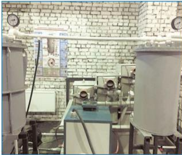
Рисунок 3.2 – Технологічна схема установки очищення бурових розчинів і бурових стічних вод електрохімічним способом
