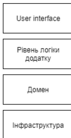
Рисунок 2.11 - Схема шарів програми за працюю Еріка Еванса «Domain-Driven Design»
