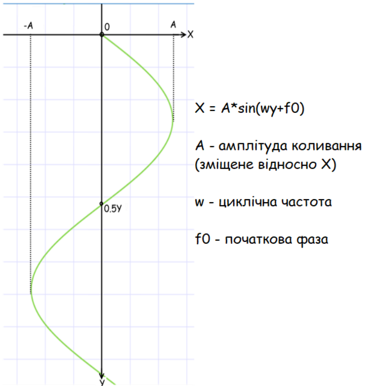
Рисунок 2.13 - Функція тригонометрії синуса
