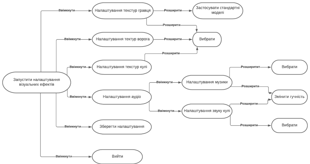
Рисунок 2.3 – Схема взаємозв'язку варіантів використання для дії "Запустити налаштування візуальних ефектів"
