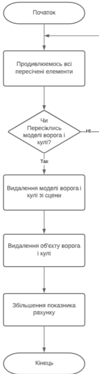
Рисунок 2.8 - Алгоритм обробки при перетині моделі противника та кулі
