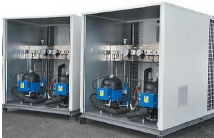
Рисунок 1.4 – Аміачна холодильна установка компанії Frigopol холодопродуктивністю 2x20 кВт для підтримання температури технологічної води в діапазоні +4...+6 °С
