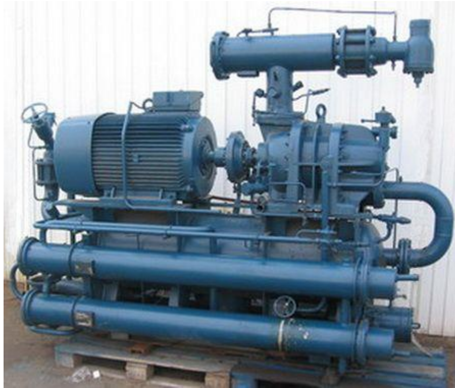
Рисунок 1.2 – Гвинтовий компресорний агрегат з масловідділювачем і водяним маслоохолоджувачем
