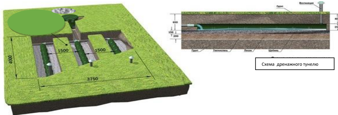
Рисунок 2.2 – Схема дренажно – фільтраційного поля
