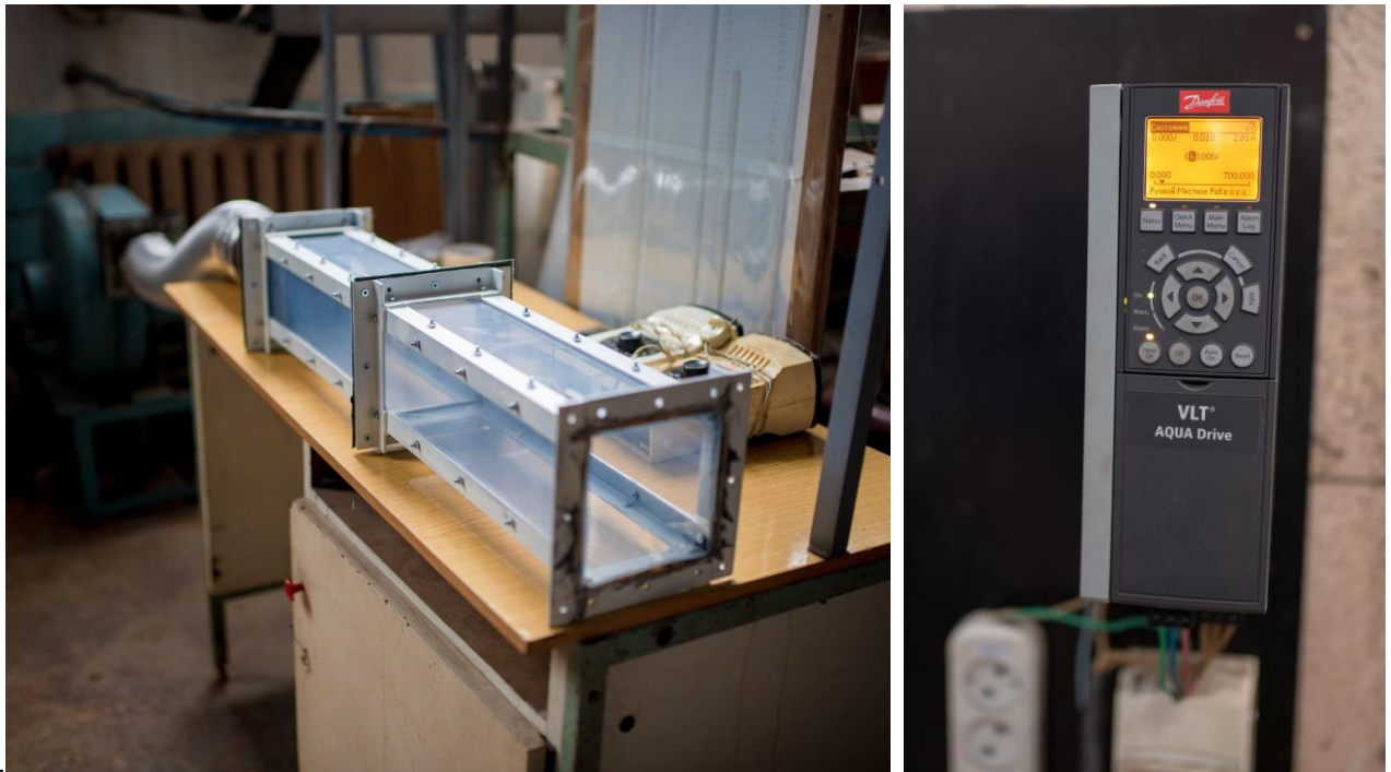
Рисунок 2.5 – Фото тестової секції (а) та регулятора частоти Aqua Drive FC 200
