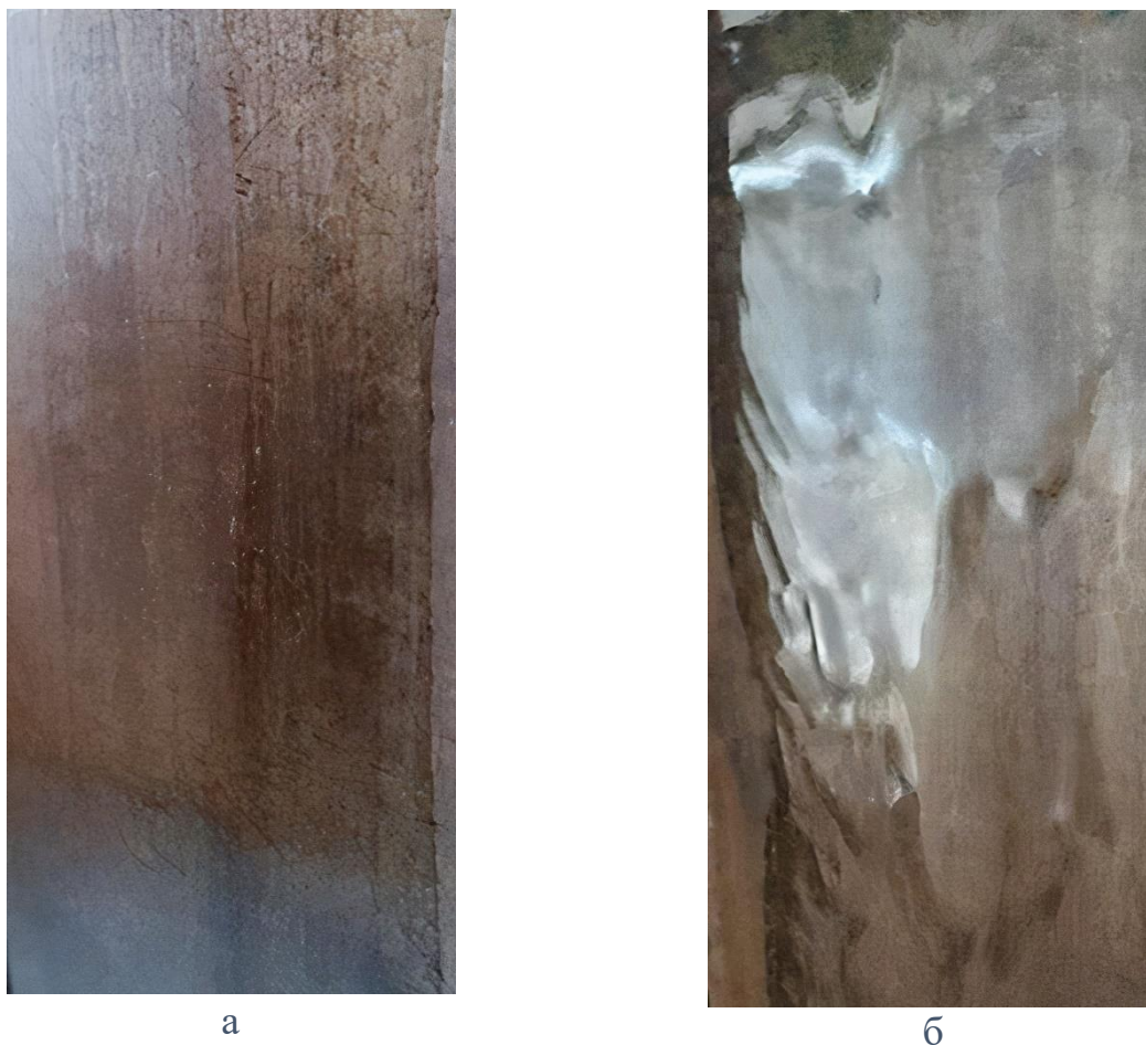
Рисунок 3.14 – Фотографія стікаючої плівки: а – ламінарний режим; б – турбулентний режим.
