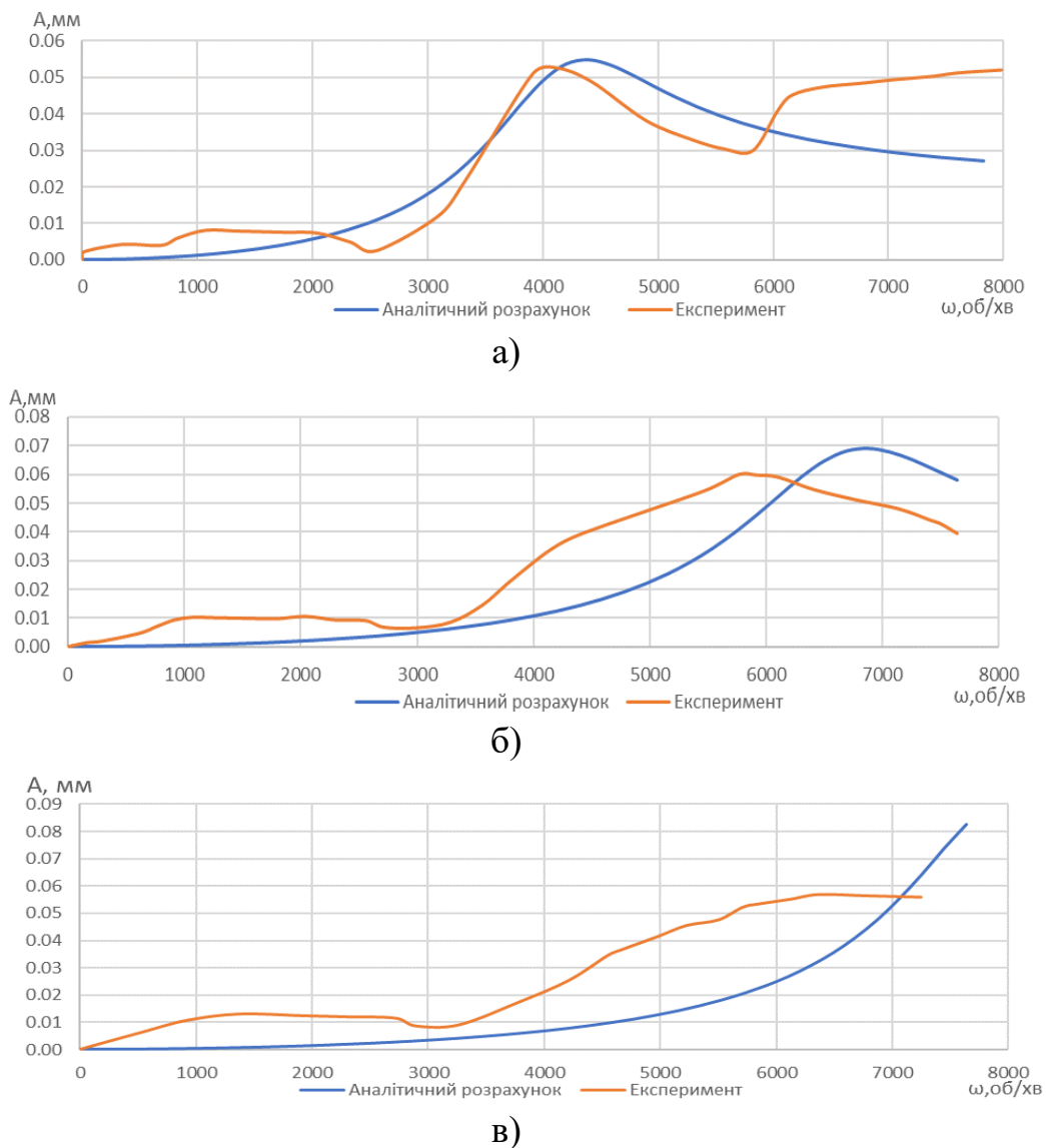
Рисунок 3.27 - Порівняння АЧХ отриманих в експерименті та в теоретичному розрахунку для другого варіанту конструкції трьохшпаринного ущільнення при K=3 мм, величина вхідного тиску: P=1,25 атм (а), P=5 атм (б), P=7,5 атм (в)
