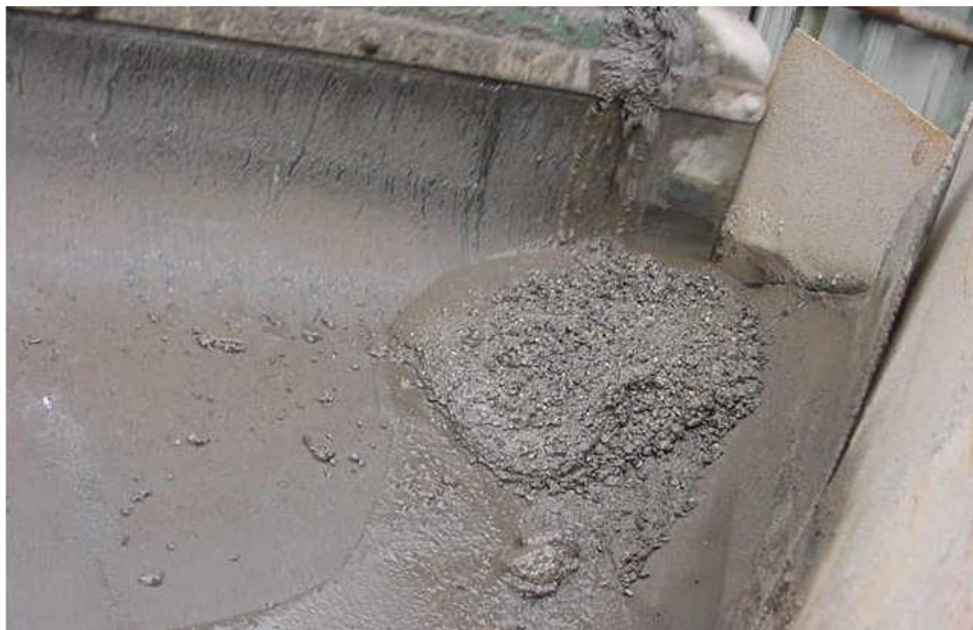
Рисунок 3.3 – Шлам із системи очистки до обробки на осушувачі шламу
