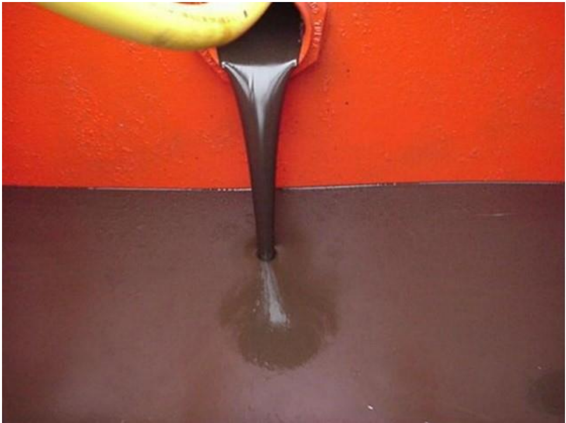
Рисунок 3.5 – Вилучений зі шламу розчин до обробки на центрифугі
