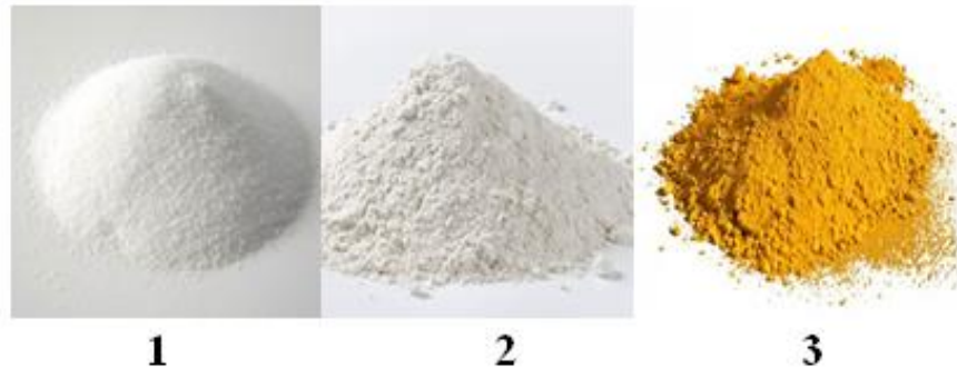
Рисунок 2.3 Наповнювачі та пігменти: 1 – мармурова крихта, 2 – діоксид титану, 3 – жовтий пігмент залізо окисний
