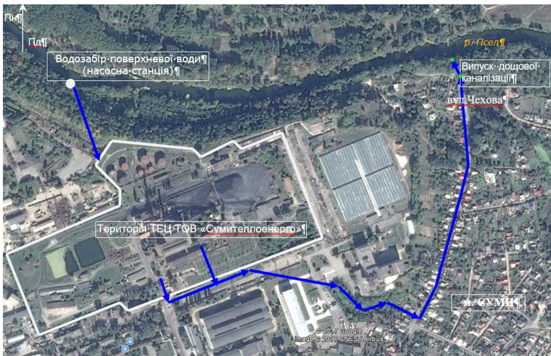
Рисунок 1.7 – Схема місць забору води та скиду зворотних вод Сумської ТЕЦ ТОВ «Сумитеплоенерго»
