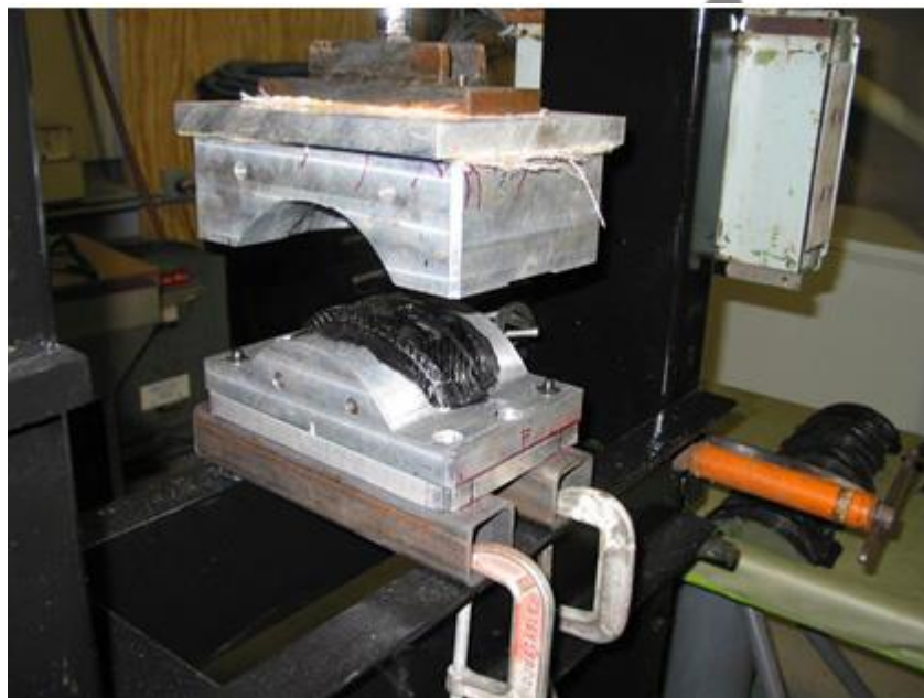
Рисунок 1.8 – Формування препрег з використанням металевих штамів.
