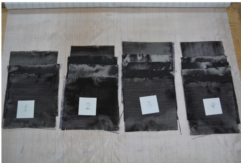
Рисунок 3.1 – Попереднє укладання розкрою тканого матеріалу по шарах.
