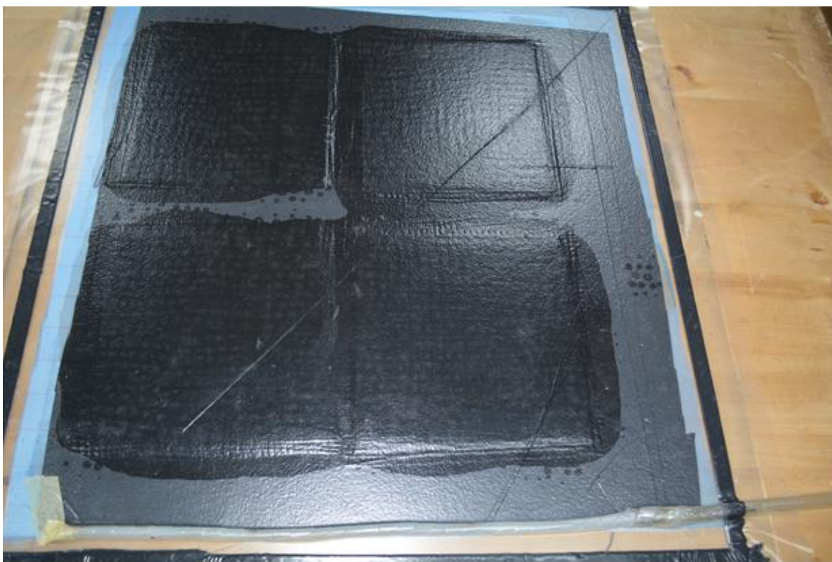
Рисунок 3.2 – Процес вакуумування зразків.
