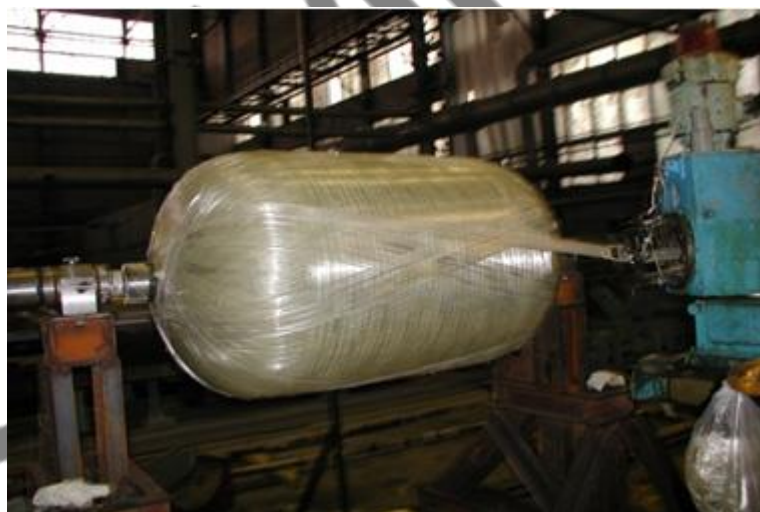
Рисунок 1.11 – Установа для намотування армуючих матеріалів.
