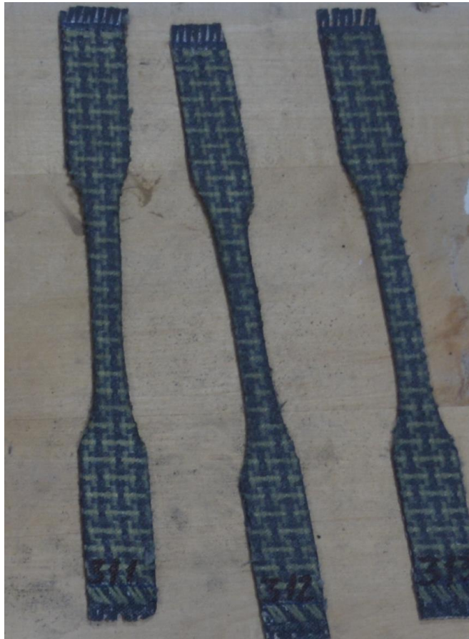
Рисунок 3.3 – Вигляд зразків для випробувань на визначення межі міцності при розриві (на етапі маркування).
