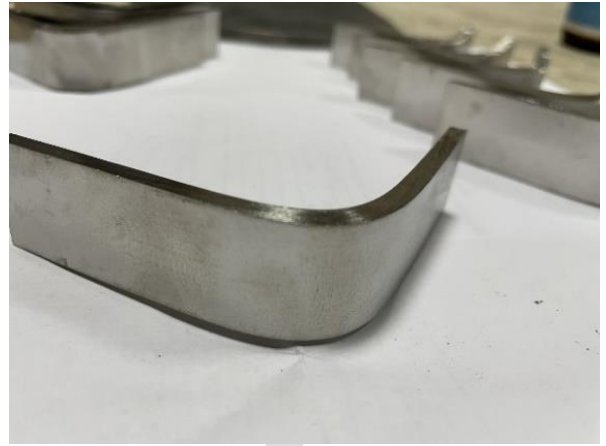
Рисунок 3.6 – Результати випробувань на стійкість до МКК
