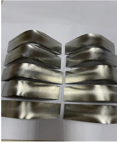
Рисунок 3.6 – Результати випробувань на стійкість до МКК
