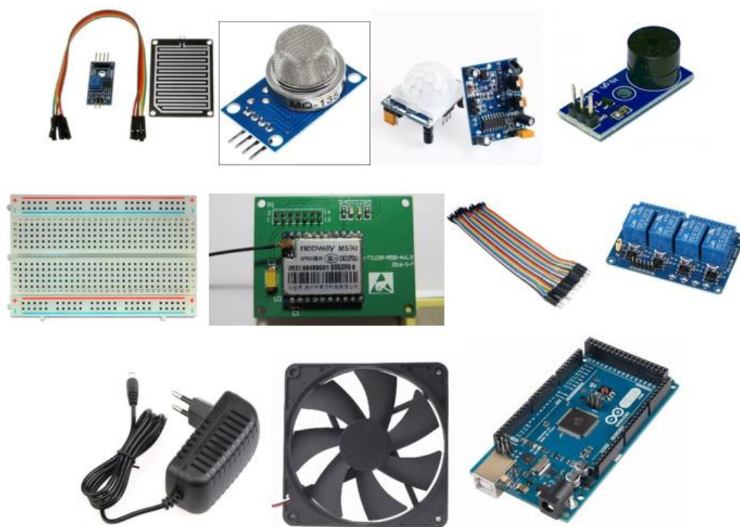
Рисунок 2.11 – Обладнання системи розумного будинку на Ардуіно
