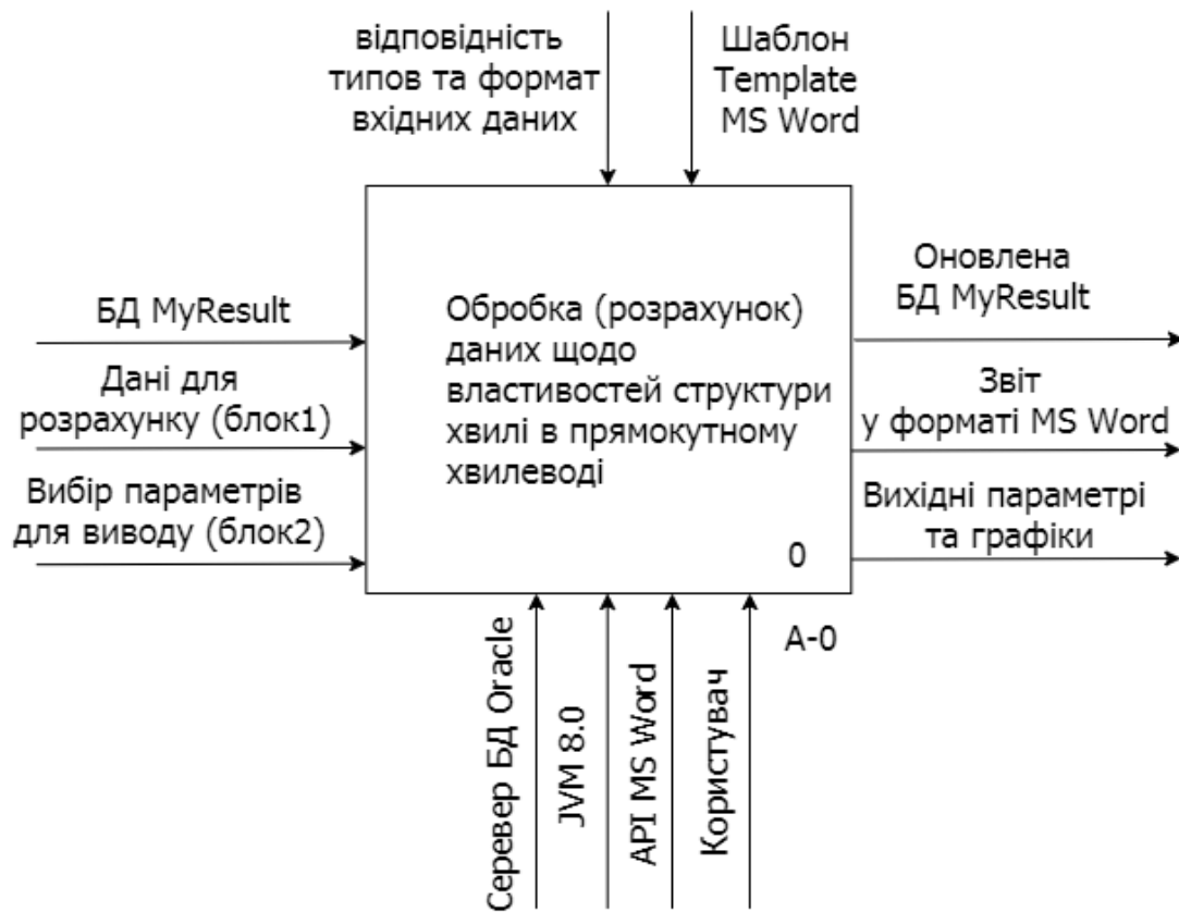
Рисунок 2.2 — Концептуальна модель - діаграма процесу обробки даних щодо хвиль в прямокутному хвилеводі
