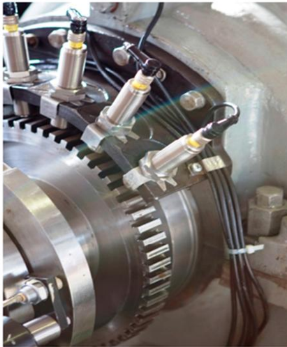
Рис. 19–Давач швидкості A5S0DD3 фірми «Braun» (а); монтаж давачів(б) Завдяки робочій частоті давача більше 25 кГц, похибка має значення \pm 0,01 Гц.
