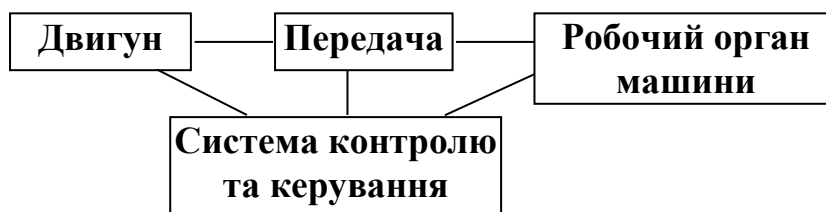
Рисунок 6.1 – Схема машинного агрегату
