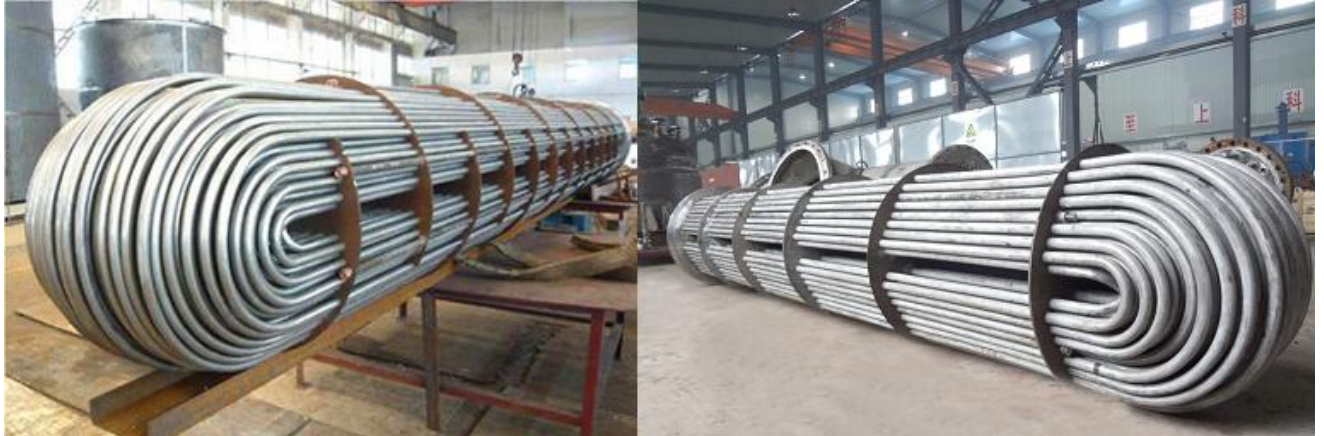
Рисунок 1.1 – Загальний вигляд трубних пучків із U-подібними трубами
