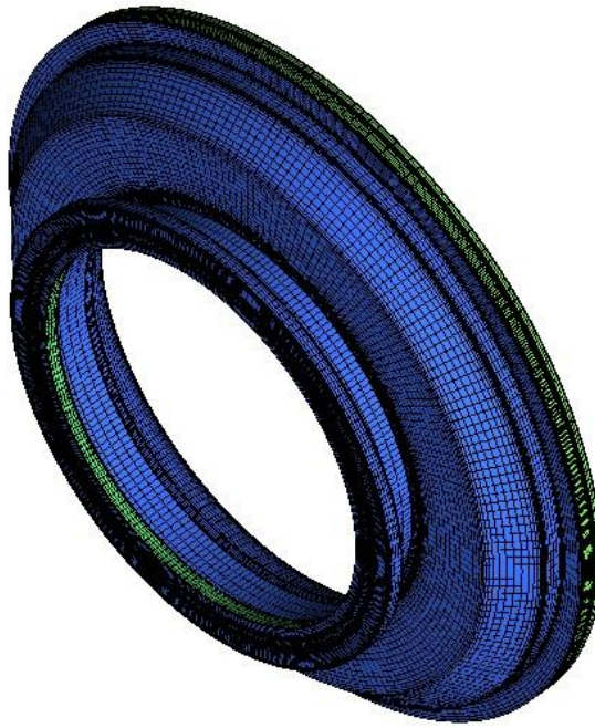
Рисунок 6.11 – Топологія розрахункової сітки для передньої пазухи із шпаринним ущільненням (1,4 млн. вузлів)
