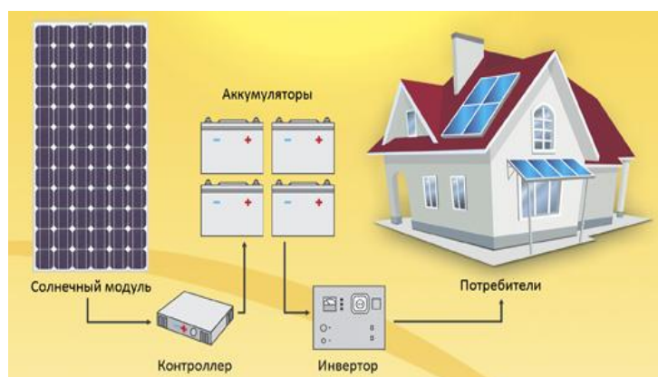
Рисунок 3.1 – Схема підключення сонячних батарей
