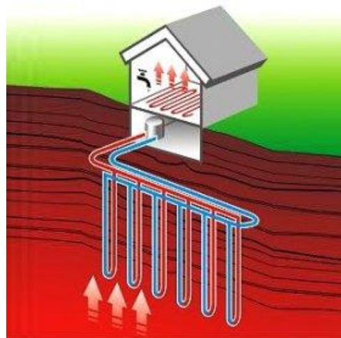
Рисунок 2.3 – Принципова схема розміщення теплового насосу
