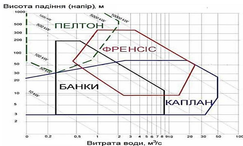
Рисунок 1.1 – Графік застосування турбін [4]
