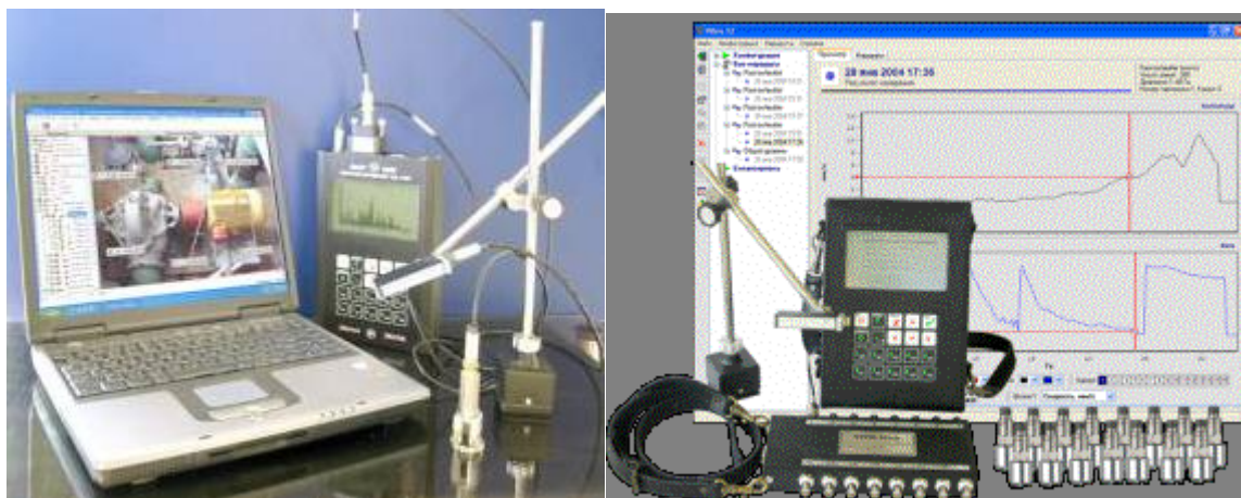
Рисунок. 2.6 Віброаналізатор СД-12М з пакетом програм DREAM виробництва Асоціації ВАСТ
