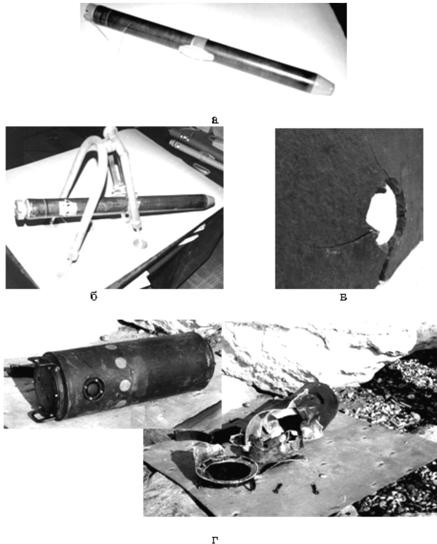
Рисунок 1 – Гидропушка ГДУ-40/20 и результаты ее применения а – ствол ГДУ-40/20, б – система обезвреживания на базе ГДУ-40/20; в – результат эксперимента по разрушению стальной пластины толщиной 6 мм; г – результат обезвреживания морской объектовой подвесной мины (масса ВВ – 25 кг, тип – МС (морская смесь: тротил, гексоген, алюминий), количество степеней защиты от обезвреживания – 5, установленная глубина – 20 м)
