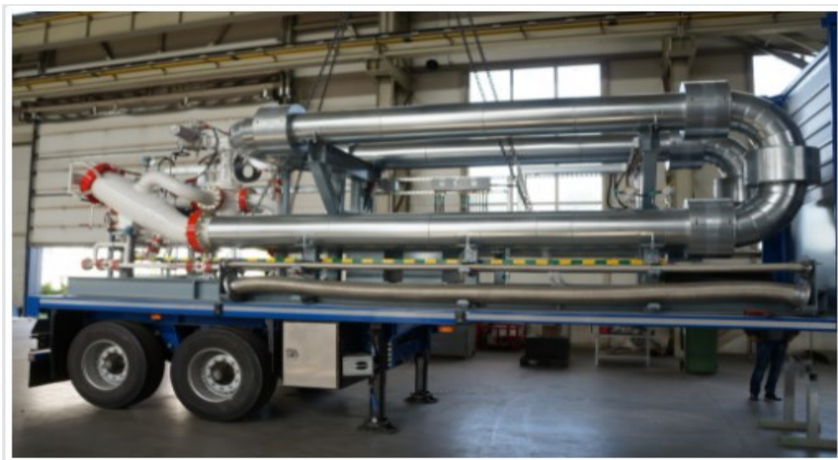
Рисунок 1 – ТПУ, 400 м 3 /год., АТ «Транснафта», РФ [33]
