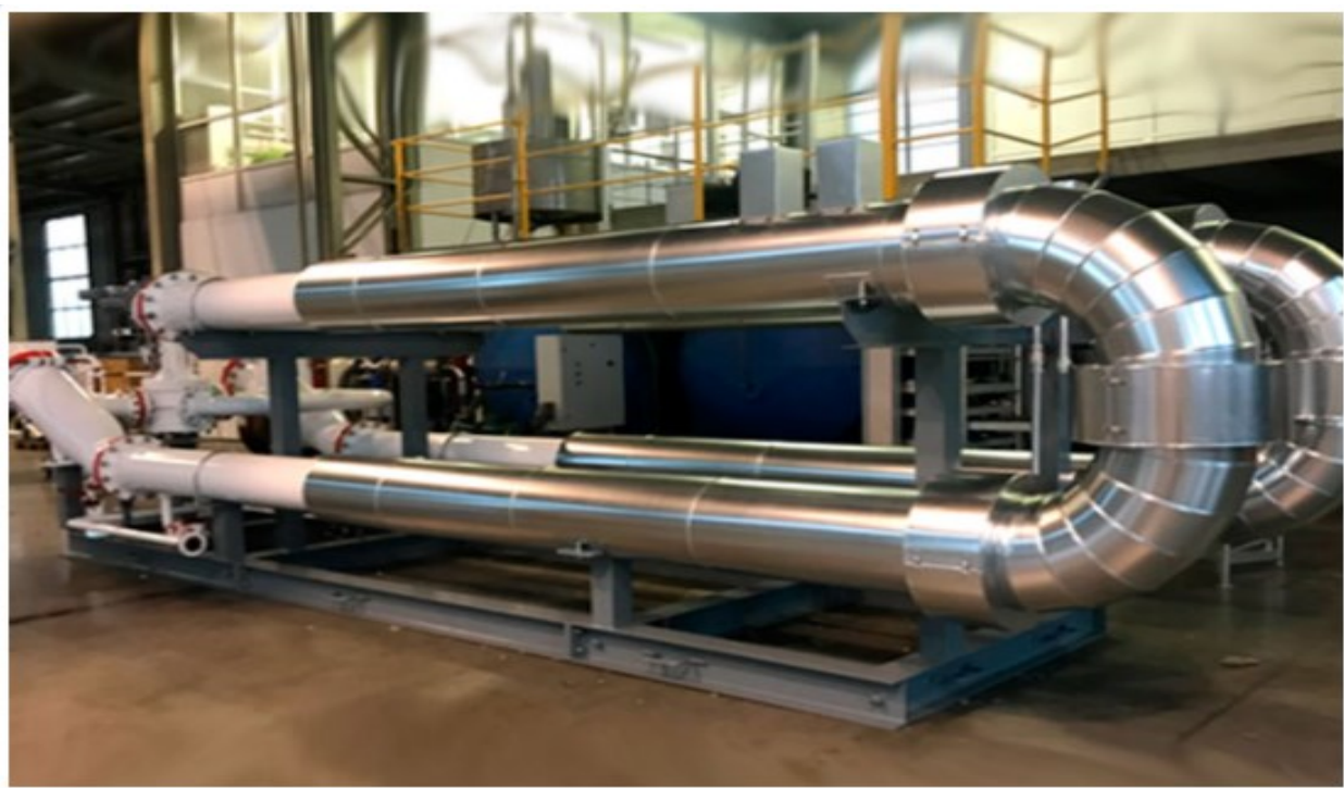
Рисунок 3 – ТПУ, 300 м 3 /год., АТ «Татнафта», ОАЕ [35]
