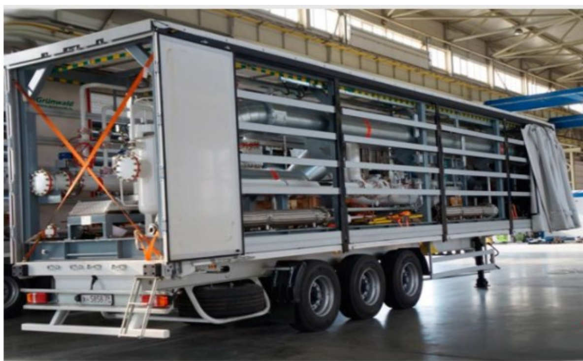
Рисунок 2 – ТПУ, 600 м 3 /год., АТ «Транснафта», РФ [34]
