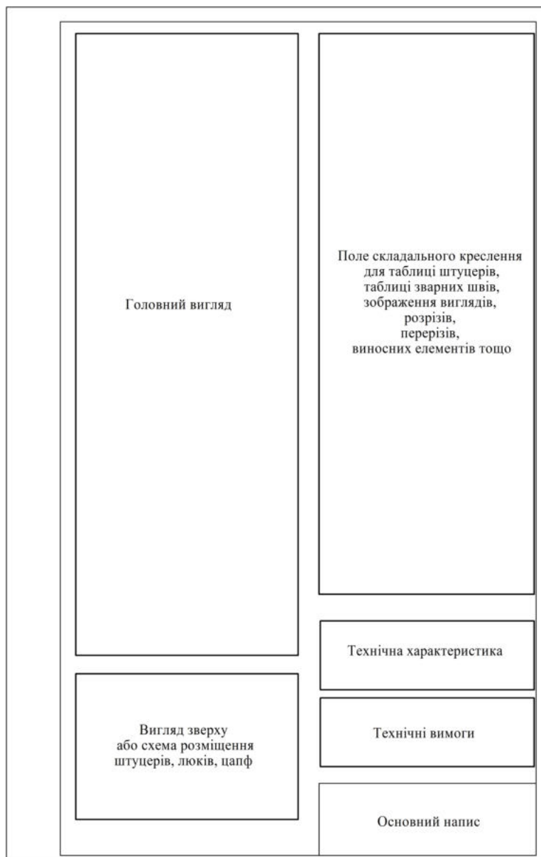
Рисунок 7.7 – Приклад компоновання елементів на полі аркуша складального креслення (варіанти книжної та альбомної орієнтацій)
