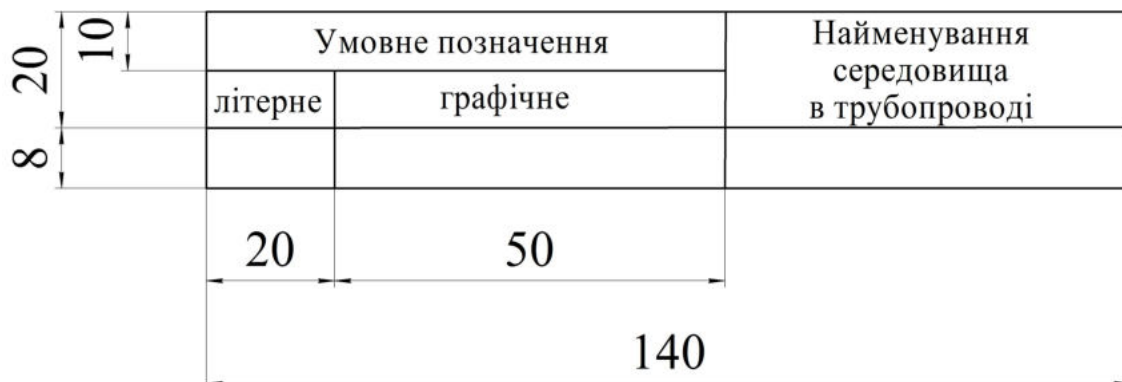
Рисунок 7.4 – Таблиця умовних позначень трубопроводів
