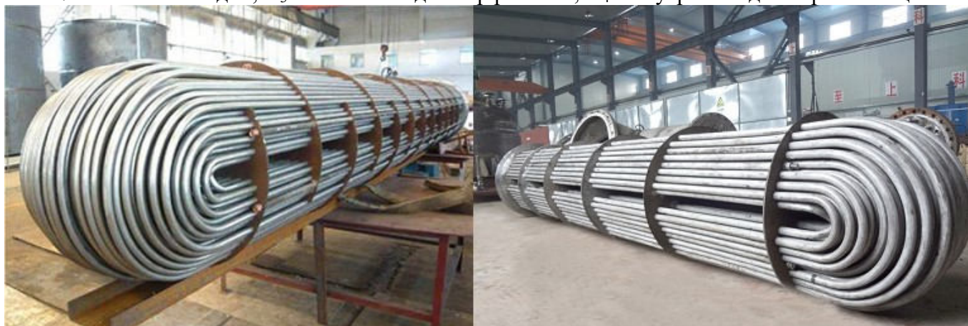
Рисунок 2.7 – Загальний вигляд трубних пучків із U-подібними трубами
