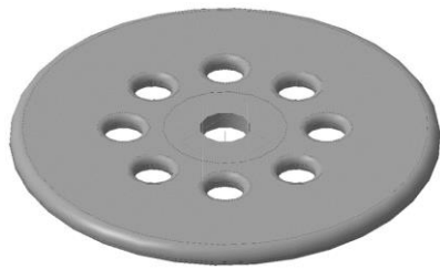
Рисунок 2 – Скоригована конструкція шайби-прихвата
