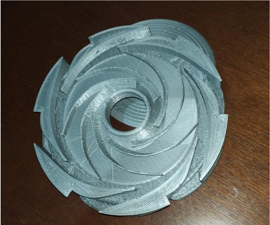
Рисунок 14 – Ступінь насоса створена методом 3D друку
