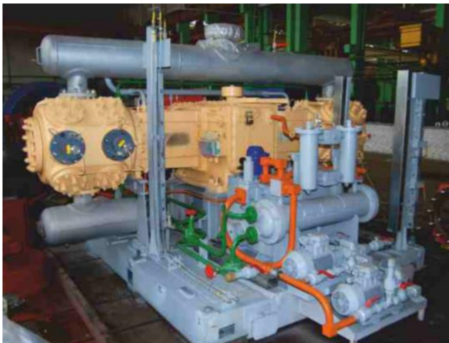
Рисунок 1.1 – Загальний вигляд компресорної установки на базі 2ГМ10А
