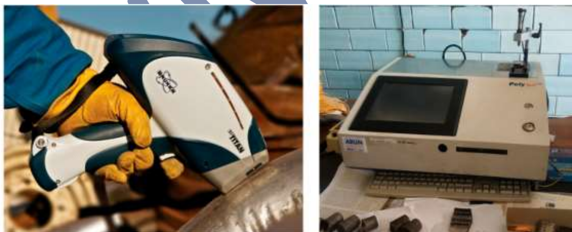
Рисунок 4.4 – Прибори для визначення хімічного складу сталі: портативний аналізатор рентгенофлуоресцентний S1 TITAN SMX 524 (а); стаціонарний спектрометр оптичний емісійний PolySpek Junior (б)
