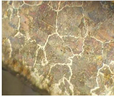
Рисунок 5.4 - Мікроструктура цементованого покриття на поверхні сталі 20, x500
