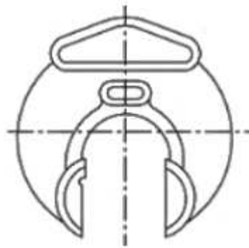
Рисунок 1.2 – Калібр-скоба нерегульована одностороння двох-гранична [1-3]
