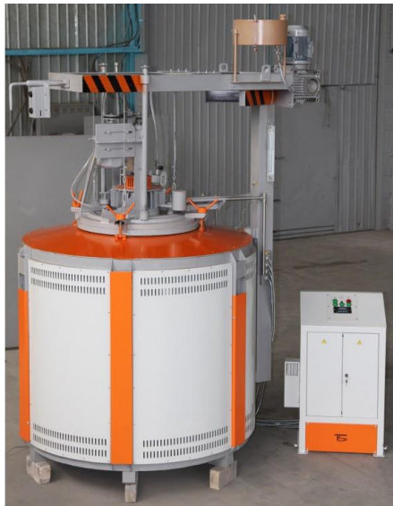
Рисунок 5.8 - Загальний вид електричної вертикальної муфельної печі для газової цементації СШЦМ: 1 - ніхромова реторта; 2 - дірчасті кошики; 3 - вентилятор; 4 - відкидні болти; 5 - теплоізольована кришка; 6 - пропелерний вентилятор; 7 – електродвигун [25]
