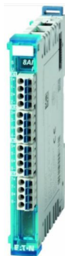
Рисунок 5.13 - Зовнішній вигляд 8-ми канального модуля аналогового введення 0/4-20мА XN-322-8AI.
