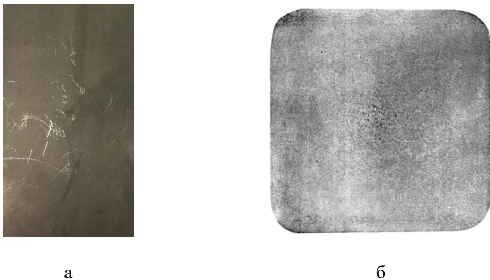
Рисунок 5.3 – Центральна пористість: а – зразок сталі у збільшенні; б – центральна пористість з оцінкою в 1 бал згідно ГОСТ 10243-75
