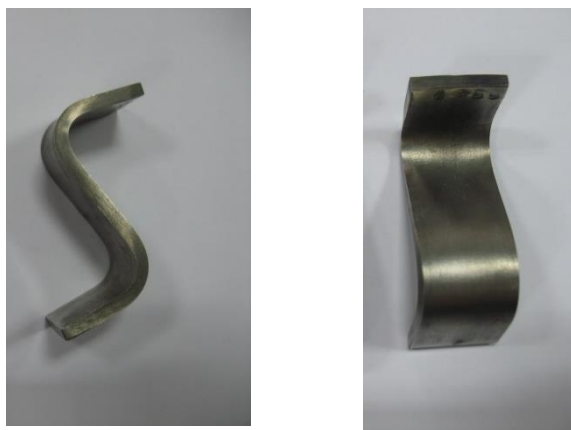
Рисунок 5.5 – Результати випробувань на стійкість до МКК
