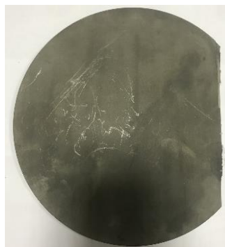
Рисунок 3.1 – Темплет зі сталі 25X17H2Б-Ш
