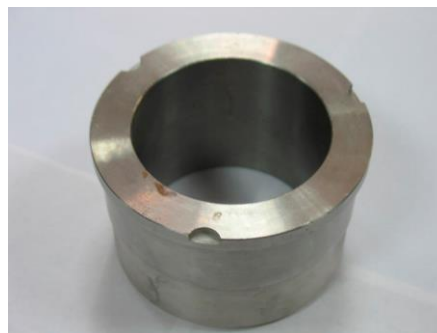
Рисунок 1.2 – Зовнішній вигляд втулки насосу ГЦН-195М
