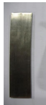
Рисунок 3.7 – Зразок зі сталі 25X17H2Б-Ш для випробування на стійкість до МКК
