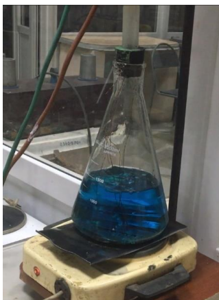
Рисунок 3.6 – Колба з реактивами для випробування зразків зі сталі 25X17H2Б-Ш на стійкість до МКК
