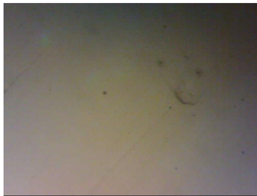
Рисунок 5.4 – Оксид точковий, сталь 25X17H2B-III
