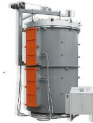
Рисунок 5.7 – Зовнішній вигляд шахтної печі з захисною атмосферою СШЗЛ – 2.4/12 [34]
