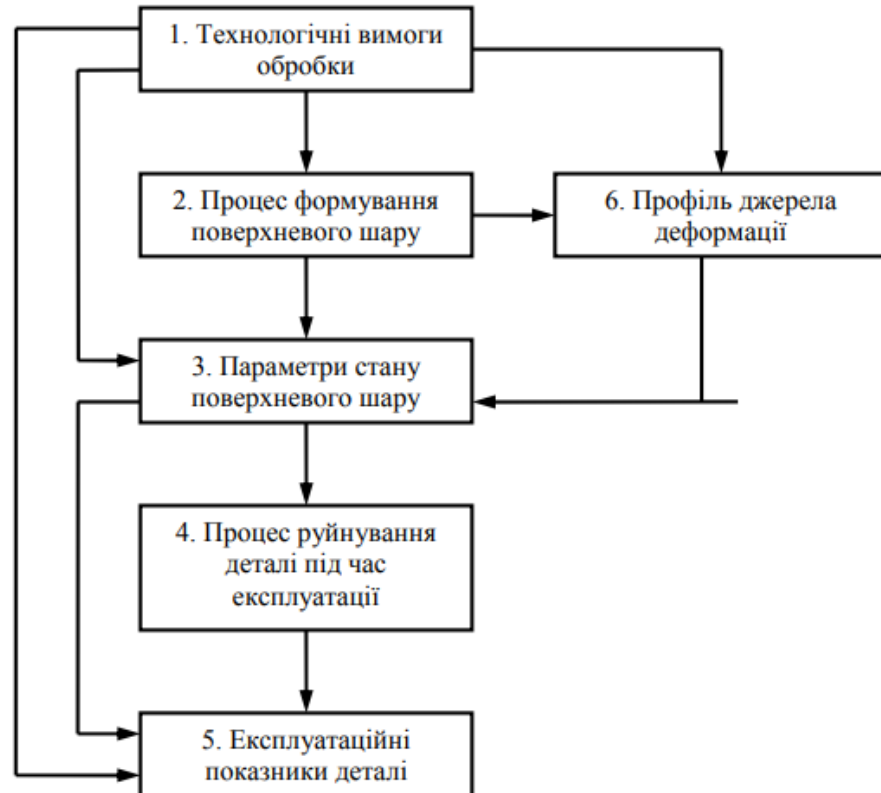
Рисунок 2.1 – Процес технологічного забезпечення якості поверхневого шару обробкою поверхневого пластичного деформування.
