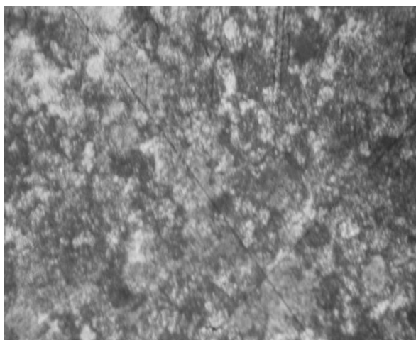
Рисунок 5.1 – Сорбітоподібний перліт та ферит після ізотермічного відпалу сталі 30ХГТ
