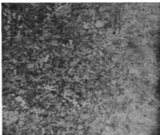
Рисунок 5.3 – Структура остаточно обробленого нітроцементованого зразка із сталі 30ХГТ
