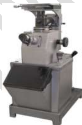
Рисунок 3.2 – Зовнішній вигляд мікроскопа МИМ-7 [67]
