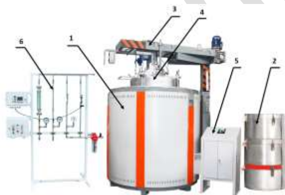
Рисунок 5.5 – Конструкція печі СШЦМ - 10.20/10: 1 - корпус електропічі, 2 - реторта з жароміцної сталі, 3 - механізм підйому кришки, 4 - кришка печі, 5 - пульт управління, 6 - газова стійка [73]
