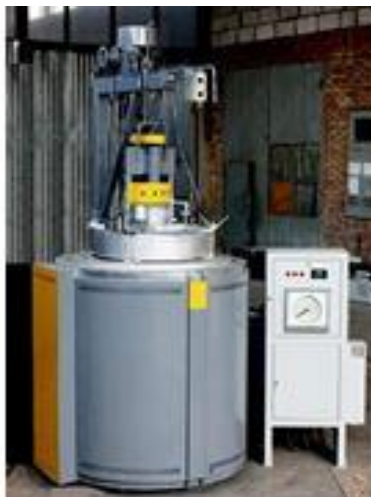
Рисунок 5.5. Піч шахтна відпускна типу: СШО 6.6/7 [35]
