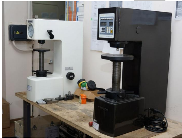
Рисунок 3.3. Твердомір ТШ-2 (з лівої сторони старого зразку, а з правої сторони оновлений) [32]
