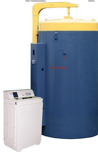
Рисунок 5.4. Піч шахтна типу: СШЗ-6.6 / 10 [35]
