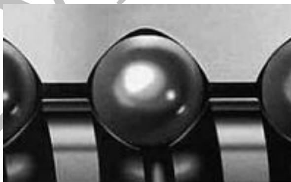
Рисунок 1.1. Перетин кулько-гвинтової передачі [3]
