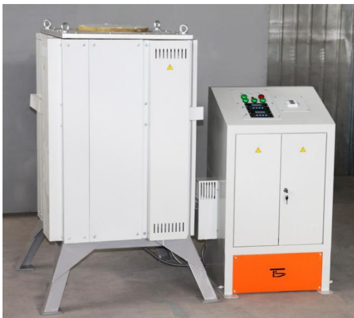
Рисунок 5.5 – Шахтна піч СШО-3.3.8/4.5
