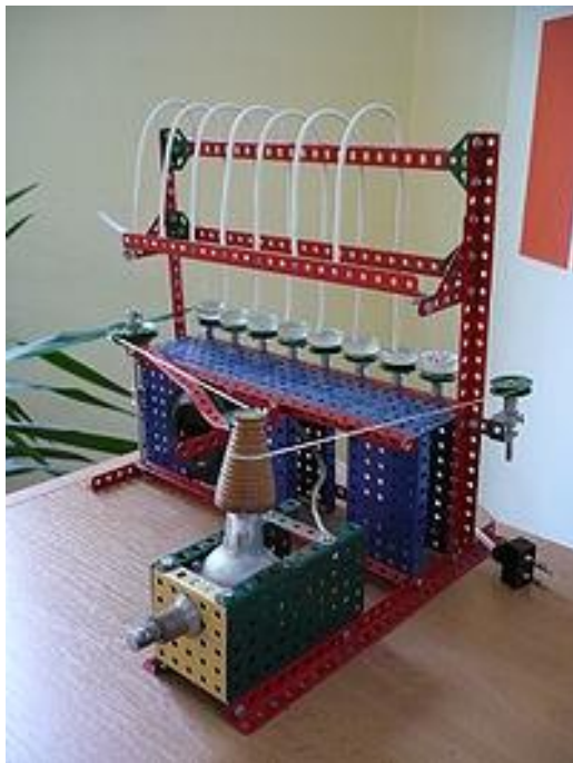
Рисунок 2.3 – Сконструйований Віхтерле з іграшки Merkur апарат для виробництва м'яких контактних лінз (музей Merkur у Полице-над-Метуї) [8]
