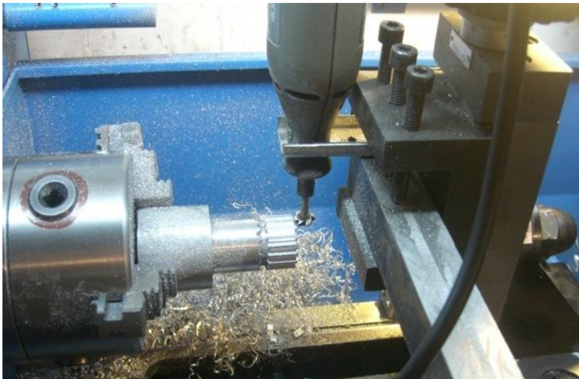
Рисунок 3.2- Закріплення граверу в різцетримач (підходить для м'яких металів та пластику)
