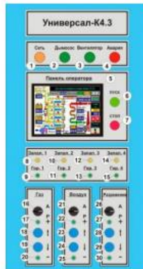
Рис. 2.5.1 Вид панелі АСУ шафи керування котлом ТВГ – 8
