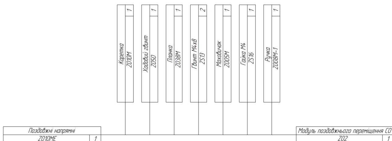
Рисунок 3.8 – Схема складання модуля поздовжнього переміщення
