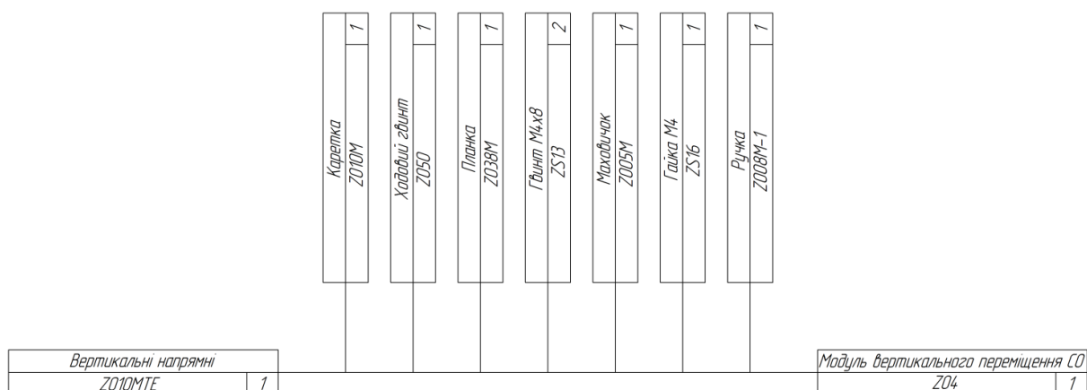
Рисунок 3.10 – Схема складання модуля вертикального переміщення
