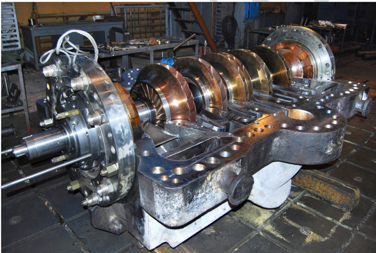
Рисунок 1.3 –Проточна частина компресора Д203ГЦ1-710/2,4-10М2 ДКС СОГ-4
