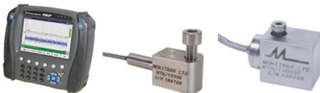
Рисунок 15 – Вимірювальне обладнання (з лівого боку: аналізатор БПФ СМХА 80, акселерометри MTN/1830 і MTN/1100)
