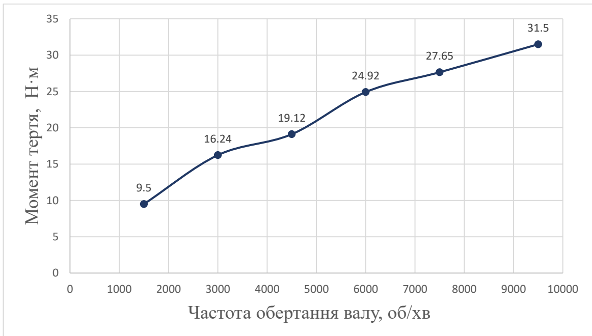
Рисунок 2.12 – Залежність моменту тертя від частоти обертання валу
