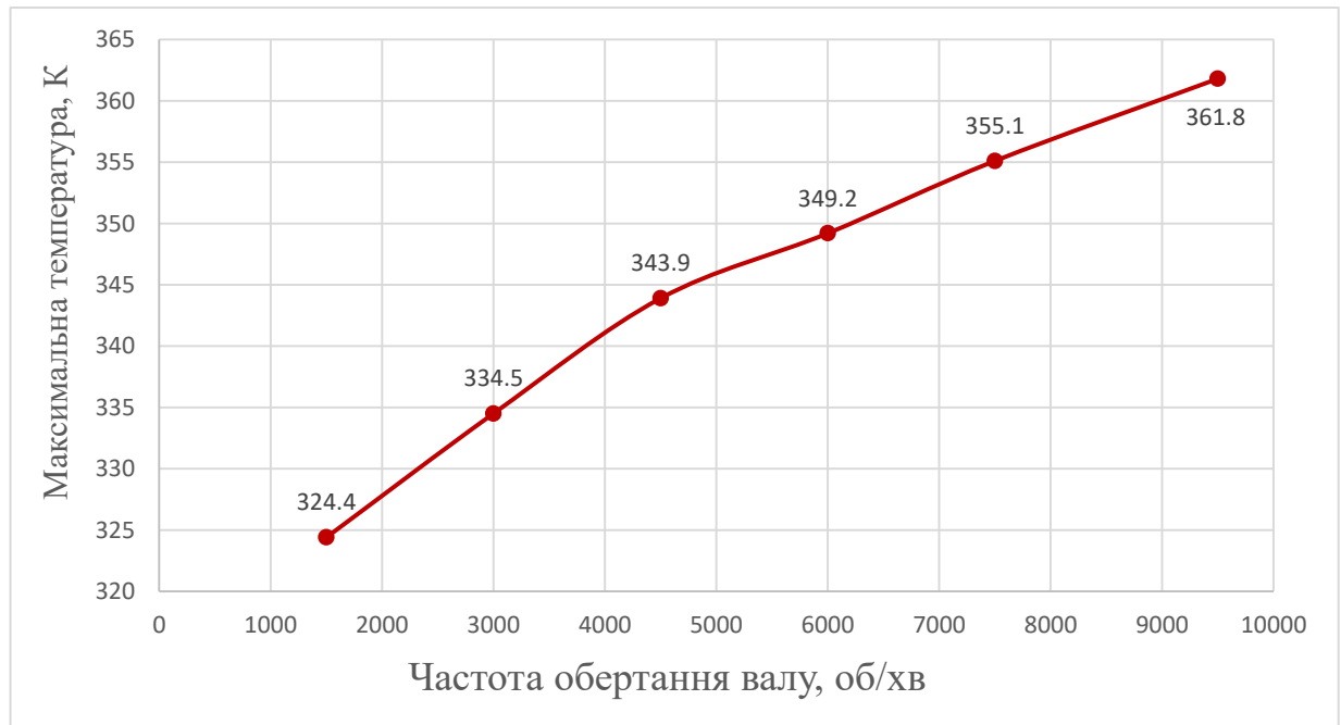
Рисунок 2.5 – Залежність максимальної температури колодок від частоти обертання валу
