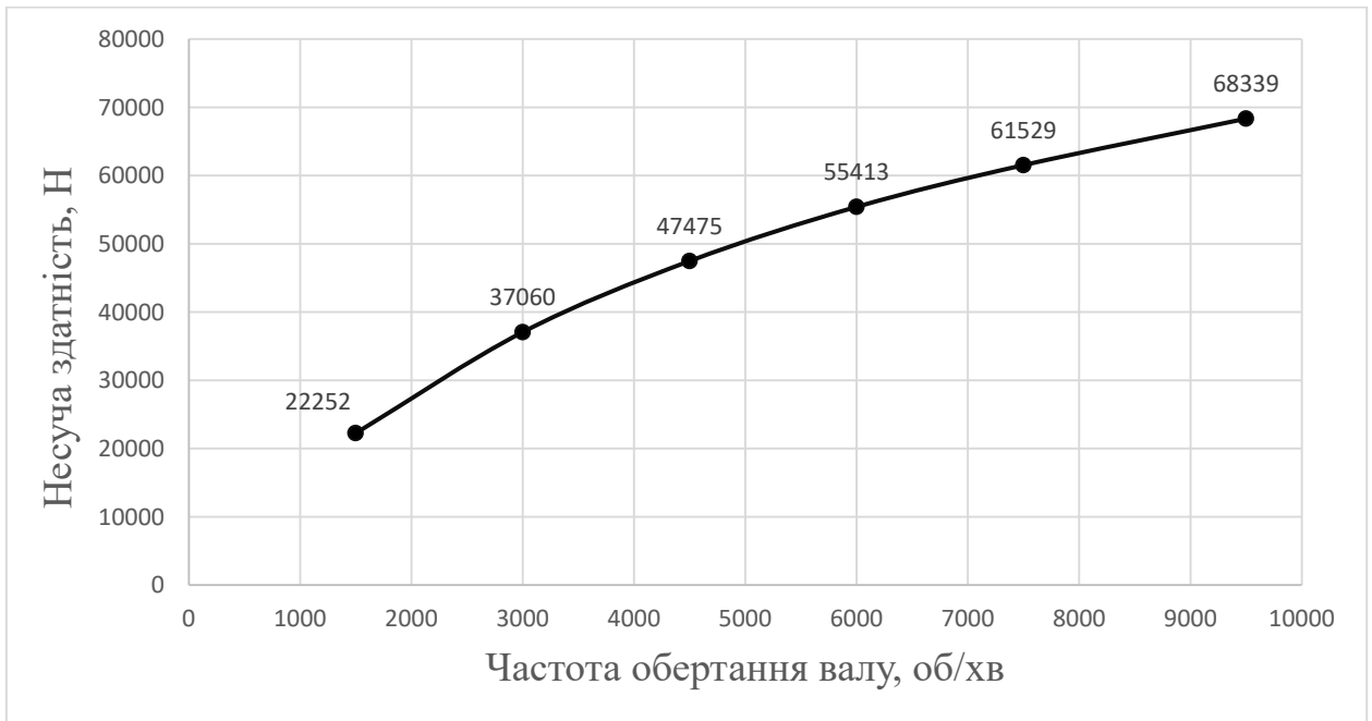
Рисунок 2.10 – Залежність несучої здатності від частоти обертання валу
