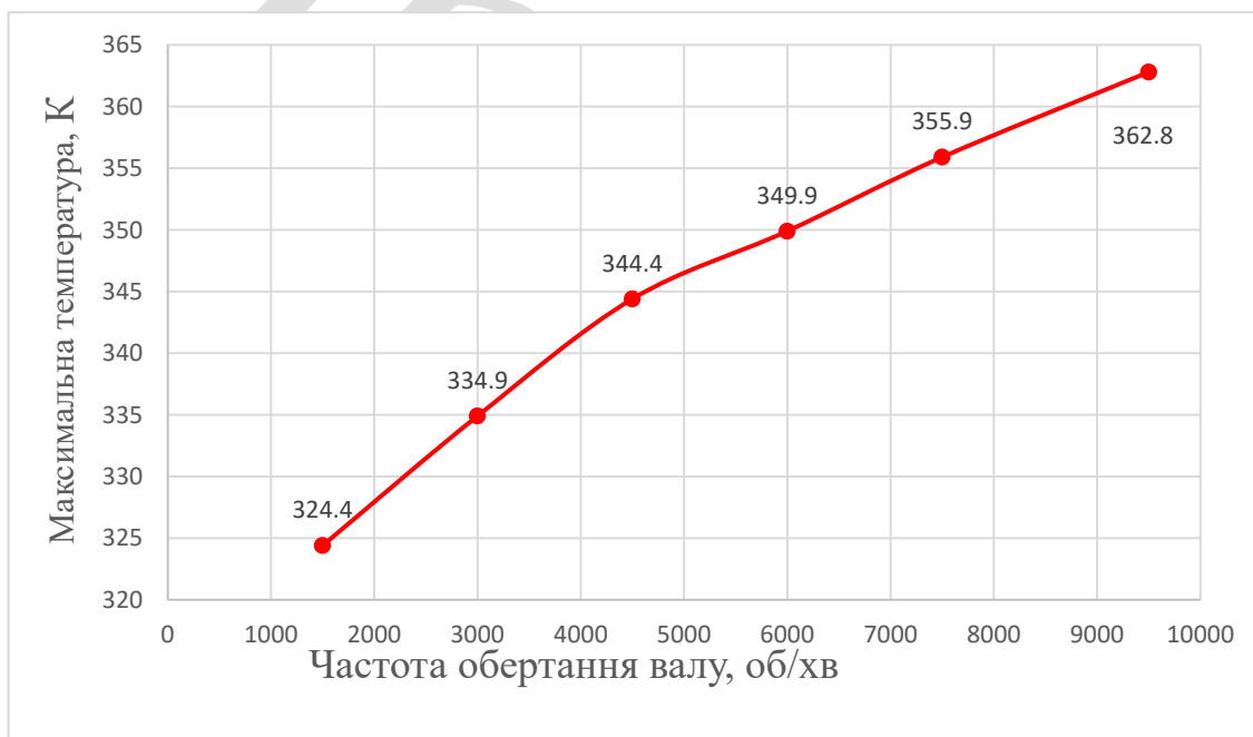
Рисунок 2.7 – Залежність максимальної температури мастильного шару від частоти обертання валу
