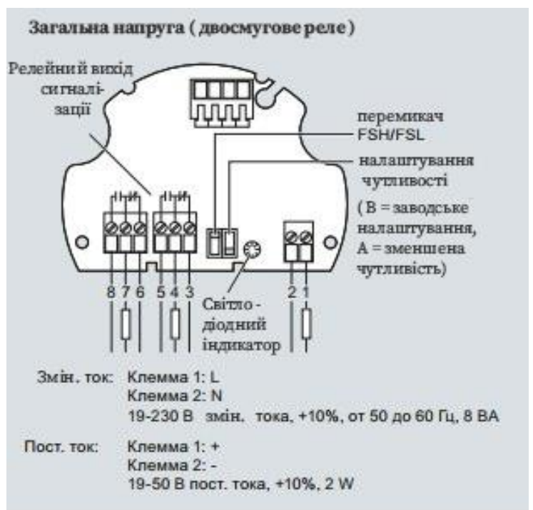
Рис. 12– Вібраційний сигналізатор рівня
