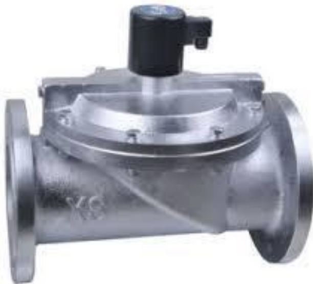
Рисунок 3.16 – Фланцевий клапан високого тиску електромагнітний клапан GAMA GF-150F DN 150 фланцевий 0.3 - 16 МПа
