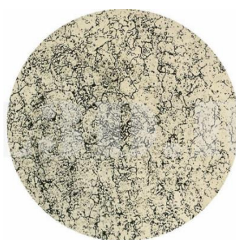
Рисунок 5.5 – Мікроструктура швидкорізальної сталі Р18 після гартування
