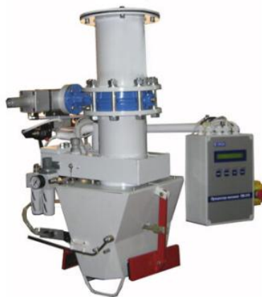
Рисунок 5.7 - Зовнішній вигляд дозатора автоматичного для сипких матеріалів ДВС-301-100-2.
