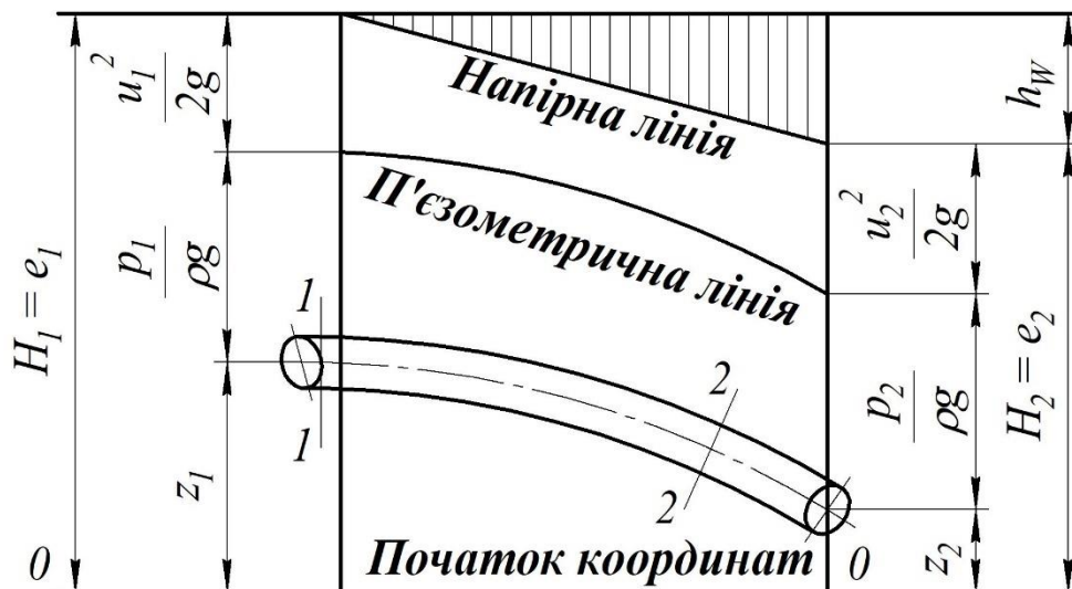
Рисунок 3.2 – Геометрична інтерпретація рівняння Бернуллі для струминки реальної рідини
