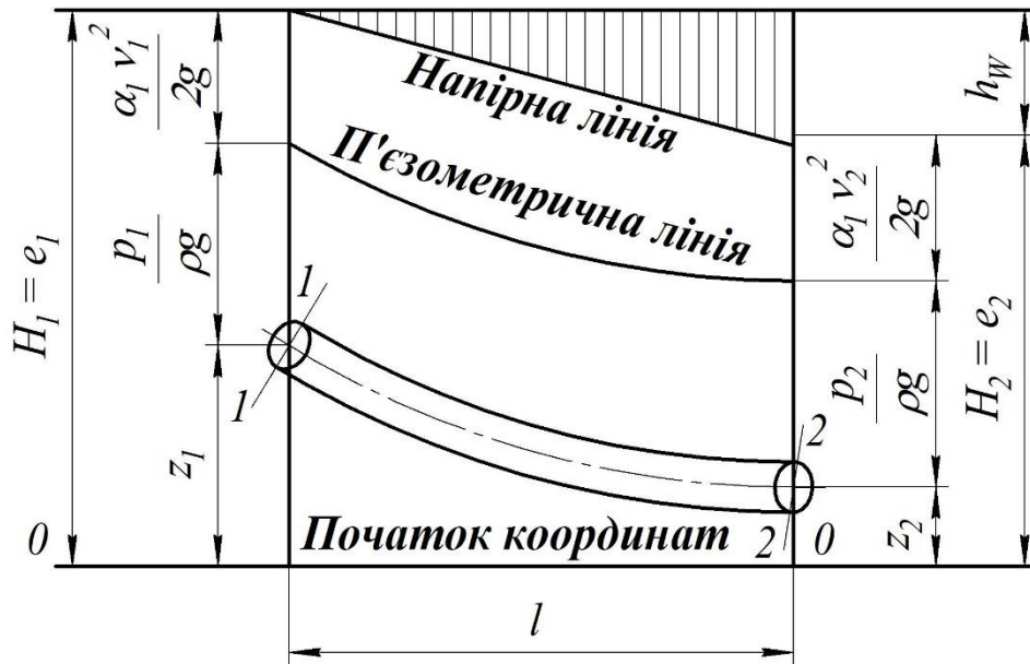
Рисунок 3.3 – Геометрична інтерпретація рівняння Бернуллі для потоку реальної рідини
